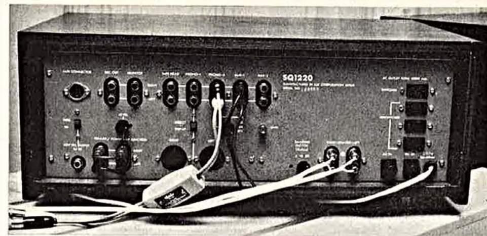
Fig 4. Bakre panelen på förstärkaren. Längst ned tv utgången för »3 D-kanalen» och över den omkopplaren till do, bredvid anslutningarna som förenar/avskiljer förstärkaren från effekt delen. Över de två urtagen för extra transformatorer syns omkopplaren för dessa. På vänstersidan finns också nivåreglaget för slutsteget. På höger sida sitter nertill, bredvid högtalaranslutningarna, omkopplaren för dämpfaktorval. Nätdelens reglage längst t h. (Foto RT)
