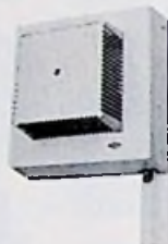
212.80 "Itho" volautomatische toiletventilator. Voor toepassing op het ontluuchtingskanaal of de buitenmuur van het toilet. Inschakeling d. m. v. een trekkoord. Acht (3+5) minuten programma. Voorzien van een automatische tijdschakelaar. Na inschakeling wordt eerst 3 minuten geventileerd bij laag toerental, waarna automatisch gedurende 5 minuten wordt overgeschakeld op hoog toerental. Na afwerking van het 8 minuten-programma schakelt de ventilator automatisch uit. Gemakkelijke montage met 4 schroeven. 59.00
